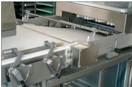
Tappeto mobile per il deposito di prodotti spezzati e/o filonati. Divider or moulded unloading belt. Movable belt to unload divided and/or moulded products.
