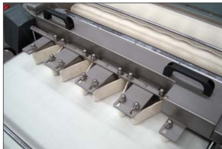
Il dispositivo di allineatura a nastri è costituito da due nastri che si muovono nella stessa direzione. Il dispositivo è installato davanti alla seconda formatrice così da centrare i filoncini nell'entrata della formatura, per un perfetto allineamento.
