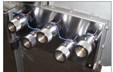
Sistema di regolazione dei 5 tappeti di riposo a seconda del numero di file utilizzato nella macchina per il carico del prodotto nelle teglie (foto indicativa).
